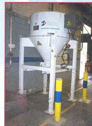
SAM 025 ATEX, aspiración de PVC granulado
