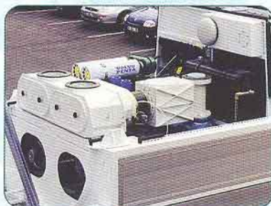
Grupo motor auxiliar diesel o toma de fuerza y bomba ROOTS trilóbulo
