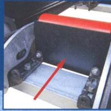
Sistema de protección de los puntos entrantes (permitiendo evitar el enganche de los dedos entre la estructura y el rodillo), conforme a las normativas europeas.
