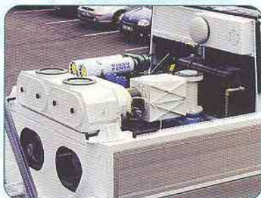
Grupo motor auxiliar diesel o toma de fuerza y bomba ROOTS trilóbulo
