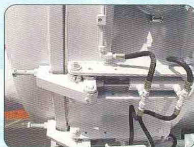
Cerramiento hidráulico del fondo de la cuba
