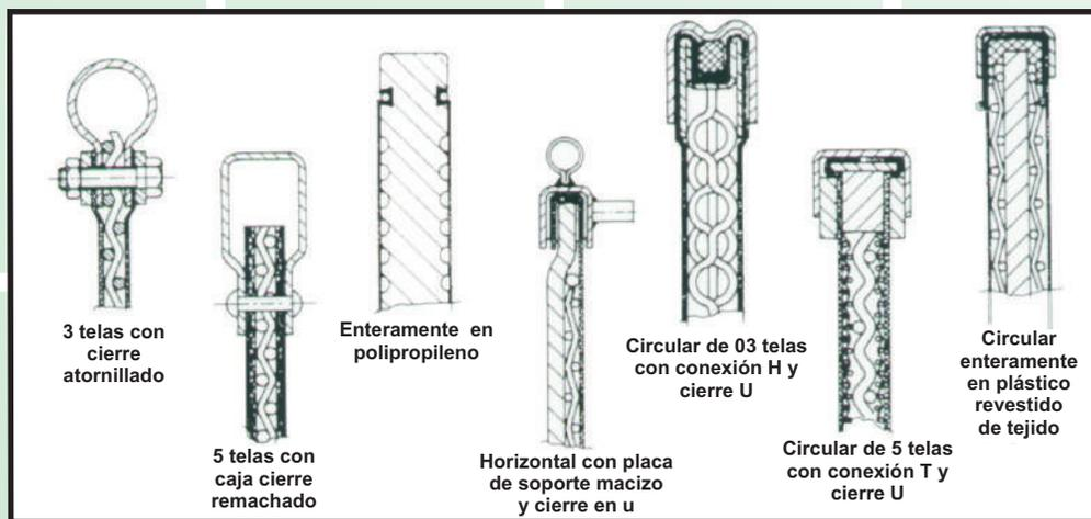
*Con excepción de las placas de plástico y polipropileno, utilizamos exclusivamente el acero inoxidable como material de construcción de los elementos filtrantes.*
