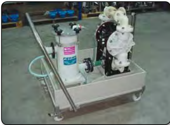
Carro de filtración portátil fabricado por el distribuidor con bomba no metálica de uso estándar.
