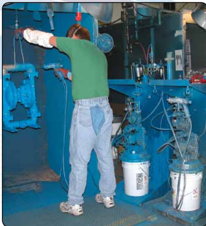
Bombas SANDPIPER® montadas en cubo instaladas en estaciones de cabinas de pulverización de pintura.
