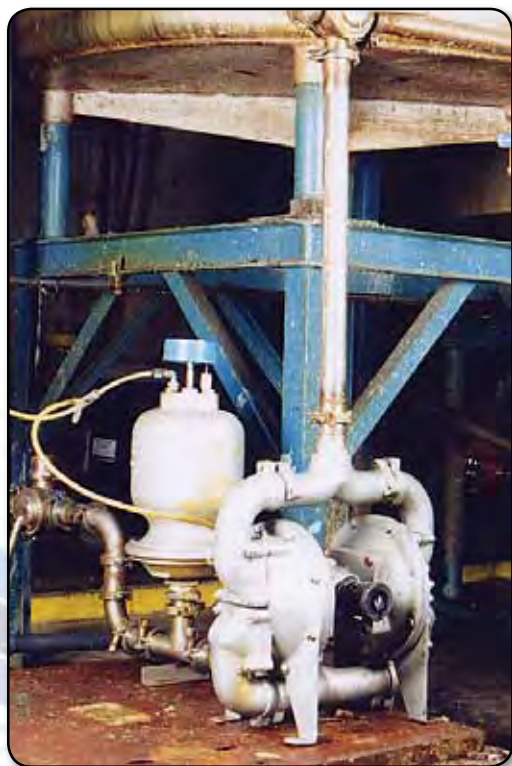
Bomba de válvula de solapa de uso intensivo instalada en una aplicación de transferencia de sedimentos de flujo inferior.
